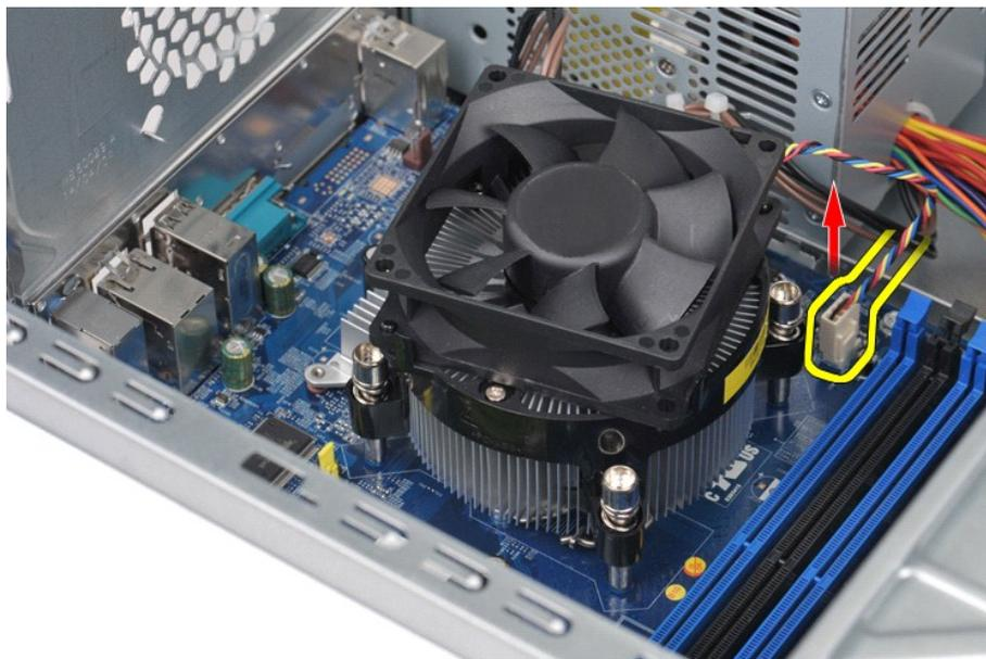
4. Con un destornillador Phillips, afloje los cuatro tornillos cautivos que fijan el conjunto de disipador de calor y ventilador del procesador a la placa base.
