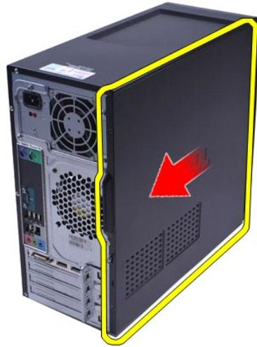
4. Levante y extraiga la cubierta del ordenador.
