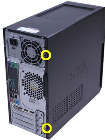
3. Deslice la cubierta hacia la parte posterior del ordenador.
