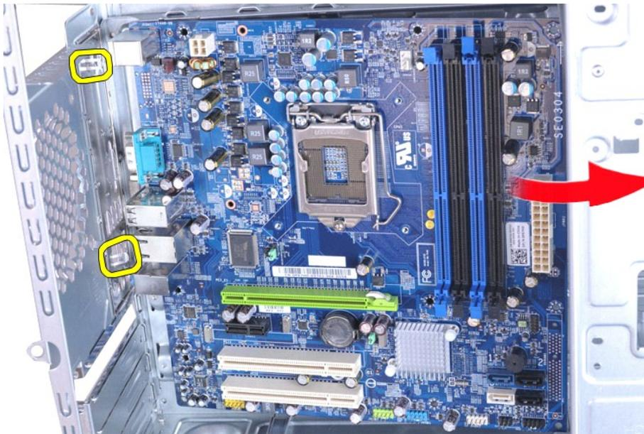
**⚠ AVISO:** Cuando vuelva a colocar la placa base, deslízela por debajo de las lengüetas metálicas. Si presiona hacia abajo la placa base mientras se encuentra encima de las lengüetas metálicas, puede resultar dañada.
