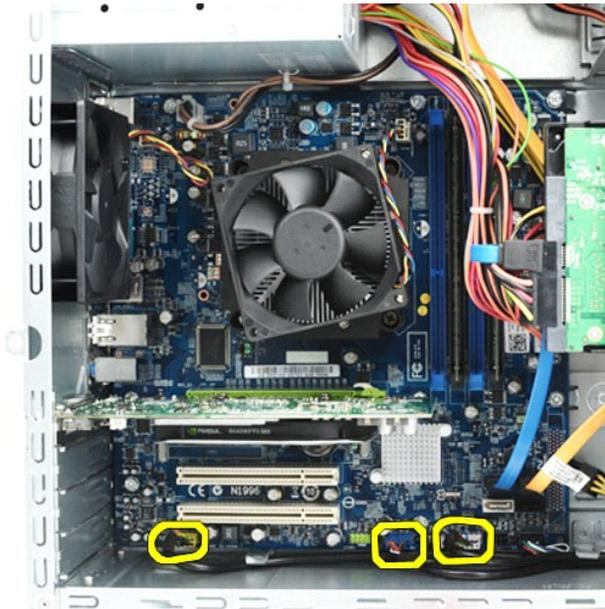
5. Retire los cables de las guías situadas a lo largo del interior del chasis.
